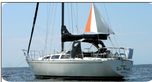
Une voile en forme de dièdre divise l'angle des embardees par \pm 4
