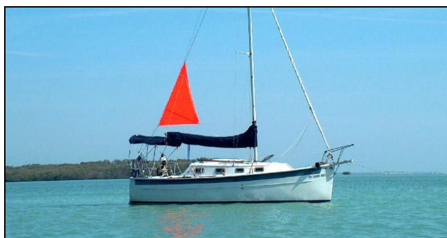
Une voile plane divise l'angle des embardees par \pm 2 .
