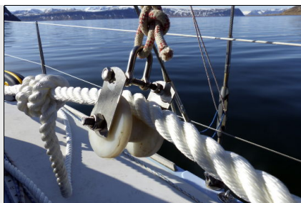
La seconde poulie est suspendue au hauban
