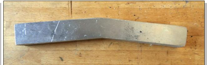
Les barres de flèche sont des profilés creux en aluminium enfichés et boulonnés sur des barreaux de section rectangulaire en forme de V traversant le mât. Elles servent à écarter les haubans du mât pour le tenir vertical et rectiligne par tout temps. Mât, haubans et barres de flèches constituent un ensemble de triangles, une structure géométrique des plus stables, largement utilisée dans les constructions de tous types. Le barreau du 3<sup>e</sup> étage est-il cassé ou plié ?
