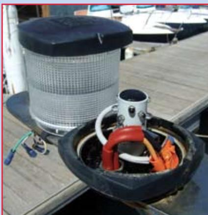
supplémentaire en tête de mât est normalement équipé d'une ampoule à incandescence de 25 W (2 A). Ce feu n'est utilisé que ponctuellement par souci de sécurité. Plutôt que de remplacer cette ampoule par une ampoule à LEDs, j'ai « bricolé » une ampoule en remplaçant son filament par un bulbe halogène G4 de 10 W, d'une luminosité à peine inférieure (consommation : 0.8 A).
